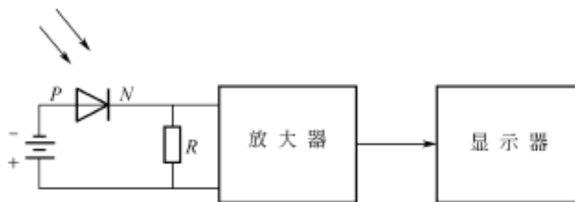
图 3-44 光电二极管的工作原理和检测电路
