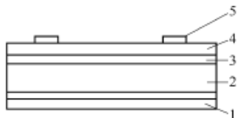
图 3-39 硒光电池的结构 1—金属片；2—半导体材料；3—氧化物层（氧化镉或铜）；4—金属导电透光膜（金或珀导层）；5—金属集电极
